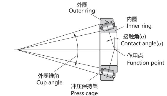
此种轴承只能限制轴或外壳的一个方向的轴向位移，承受一个方向的轴向载荷。在径向载荷的作用下，轴承内产生的轴向力亦须加以平衡。应将两个轴承面对面或背对背配置使用。
