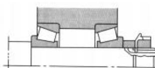
图5.1 定位预载荷示意图
