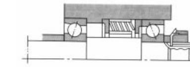
图5.2 定压预载荷示意图
