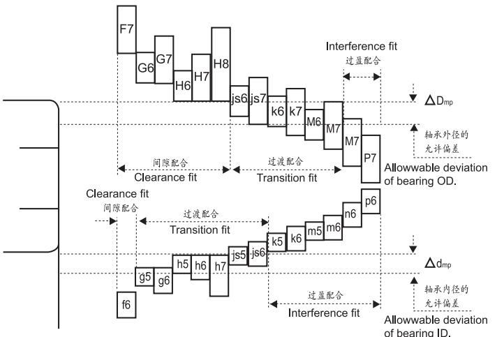
图7.1 轴和外壳孔的尺寸公差与配合的关系 (0级公差的轴承)
