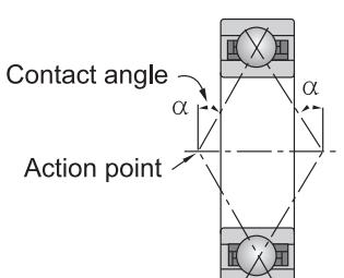
四点接触球轴承QJ000(176000)型为分离型轴承。具有双半内圈，接触角35°。
